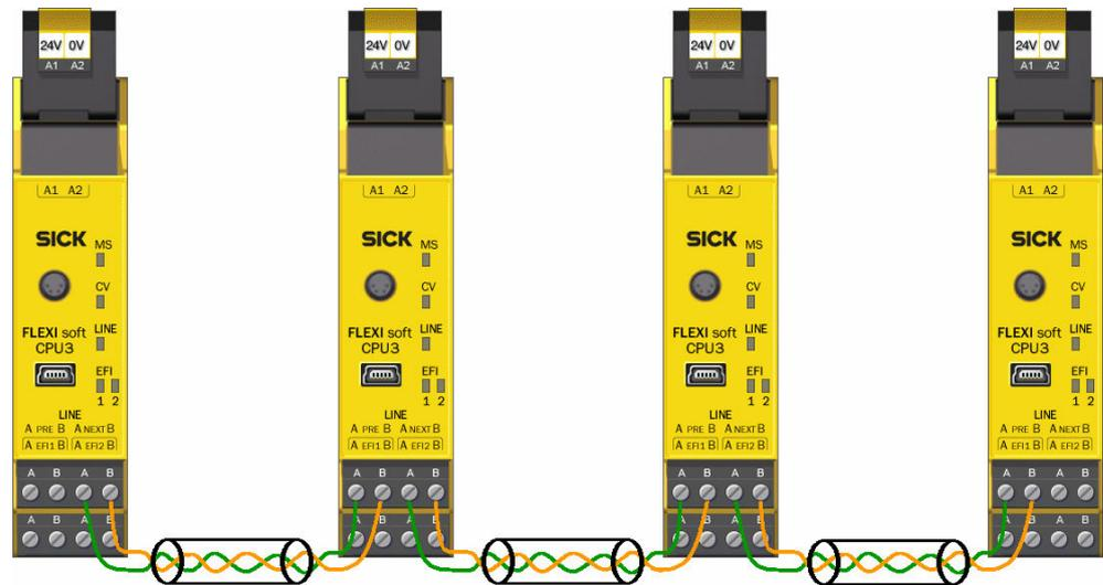
Illustration 56 : Raccordement d'un système Flexi Line
