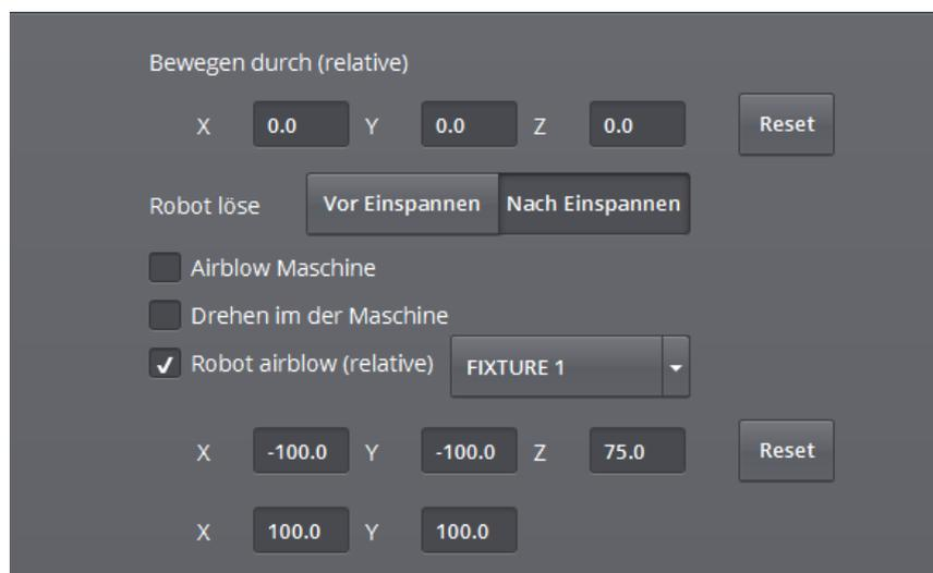
Abbildung 31 - Airblow (im Fenster Beladen) konfigurieren
