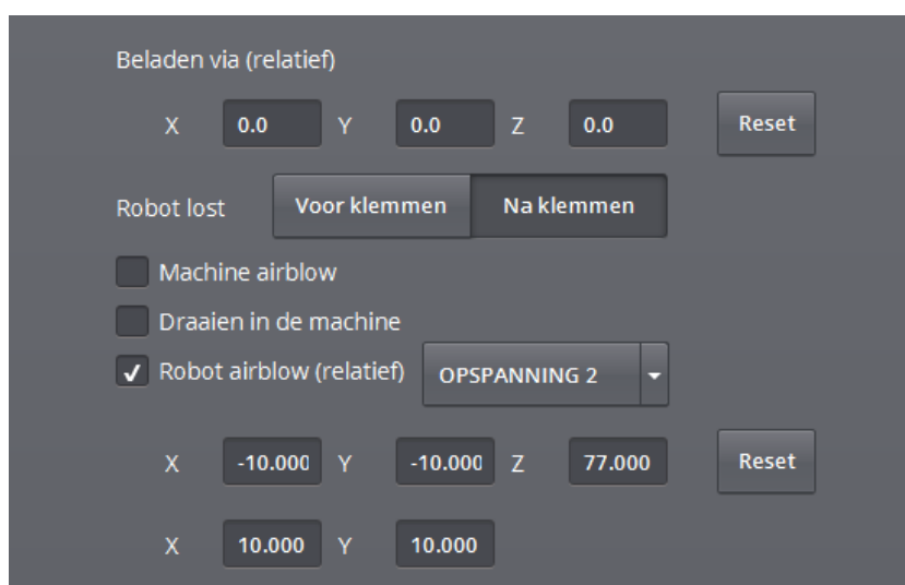
Figure 31 - Configuration du jet d'air (Chargement)
