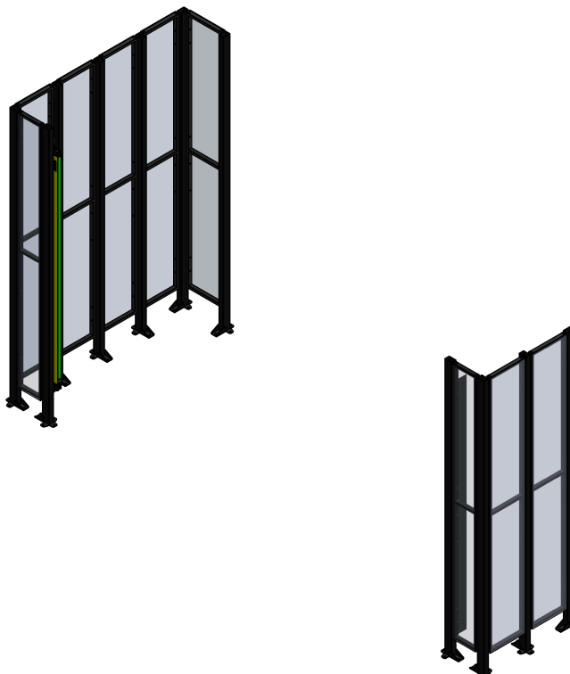
Abbildung 2.10. Sicherheits-Absperrung mit Sicherheits-Lichtschanke
