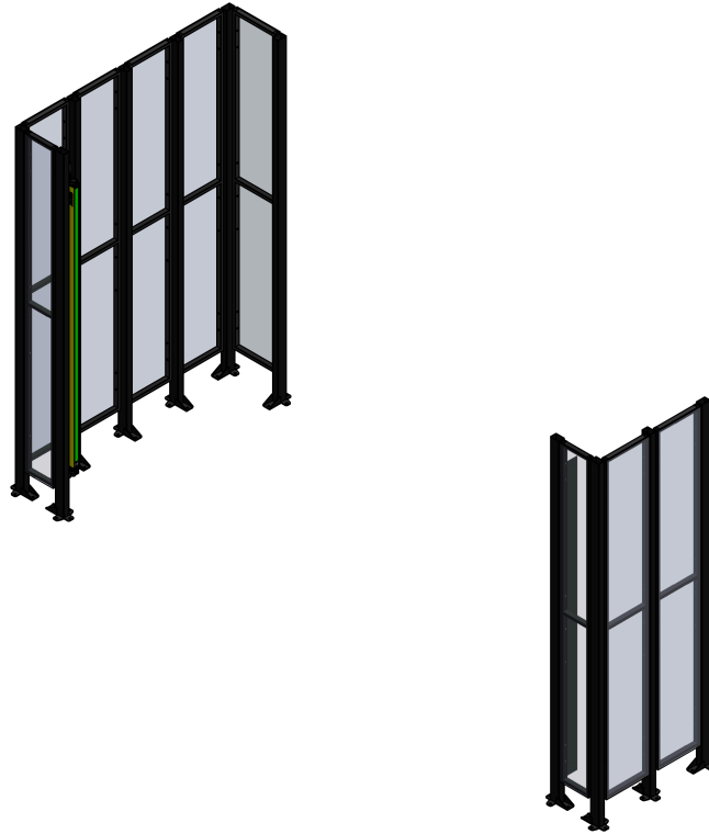
Abbildung 2.25. Sicherheits-Absperrung mit Sicherheits-Lichtschanke
