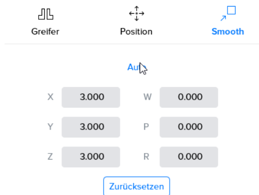
Abbildung 3.68. Weich - Smooth für Ablegen (Put) konfigurieren
