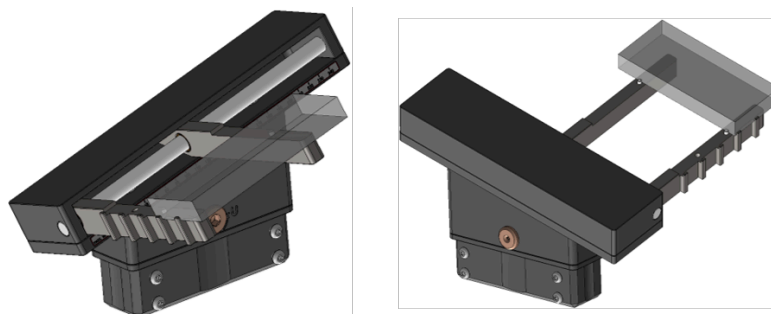
Abbildung 3.47. Wendeeinheit mit verschobenem Ausgangspunkt (Origin)(Mill-Assist)
