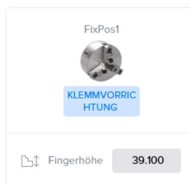
Abbildung 3.43. Klaue Höhe für Klemmvorrichtungen für Drehmaschine
