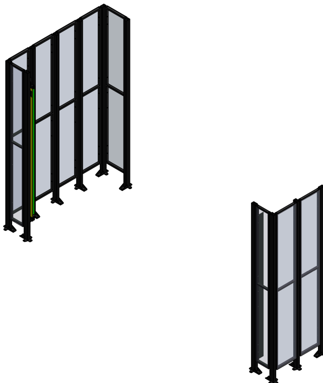
Abbildung 2.17. Sicherheits-Absperrung mit Sicherheits-Lichtschanke
