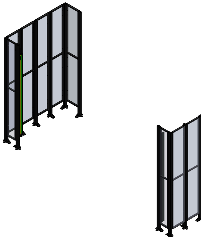
Abbildung 2.15. Sicherheits-Absperrung mit Sicherheits-Lichtschanke
