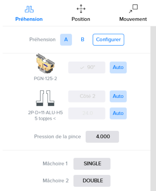
Figure 3.38. Zone Pince de préhension de l'écran de positionnement : Pinces de préhension à deux points
