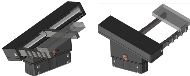
Figure 3.33. Unité de basculement assortie d'une origine décalée
