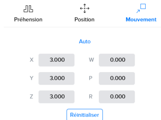
Figure 3.48. Configuration d'un déplacement en douceur associé à une opération de mise en place
