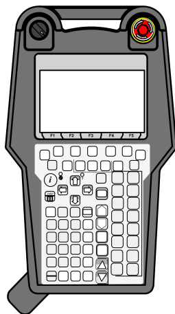
Figure 3.53. Activation du commutateur monté sur le Teach Pendant
