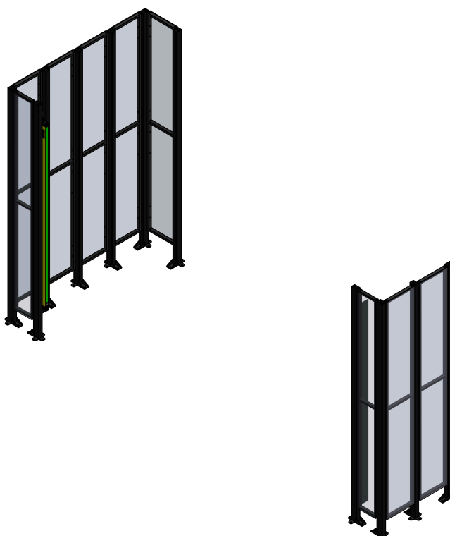
Figure 2.9. Enceinte de sécurité pourvue d'un rideau lumineux de sécurité
