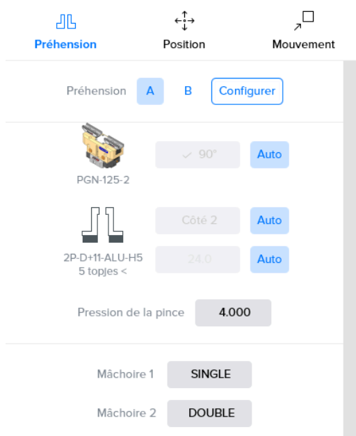
Figure 3.54. Zone Pince de préhension de l'écran de positionnement : Pinces de préhension à deux points
