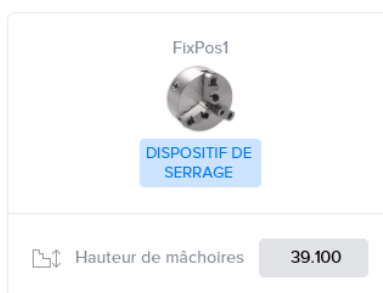
Figure 3.43. Hauteur des mors de serrage d'un tour
