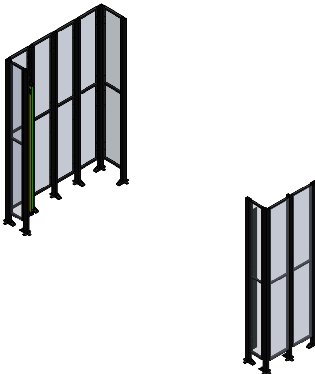
Figure 2.16. Enceinte de sécurité pourvue d'un rideau lumineux de sécurité
