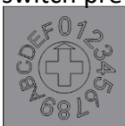
Figure 4.3 : DIP switch pour régler le numéro de sous-préhenseur
